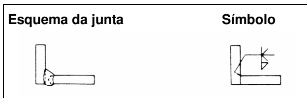
Combinação de chanfro em K e solda em filete
